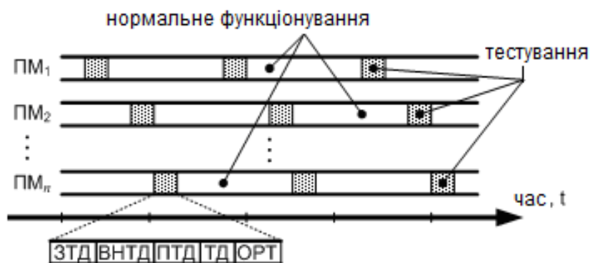
Рис. 3. Структура діагностичного модуля з інтелектуальними властивостями
