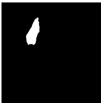
Рис. 6. Бінарне зображення, отримане в наслідок використання фільтра з пороговим значенням threshold = 120
