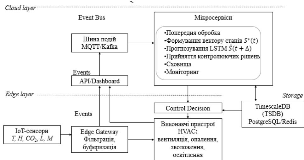
Рис. 1. Високорівнева архітектура edge-cloud платформи клімат-контролю на основі подієво-орієнтованих мікросервісів та шини подій MQTT/Kafka
