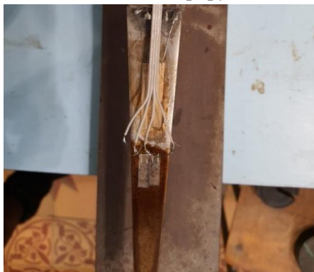
Рис. 5. Розміщення тензорезисторів на тарирувальній балці
