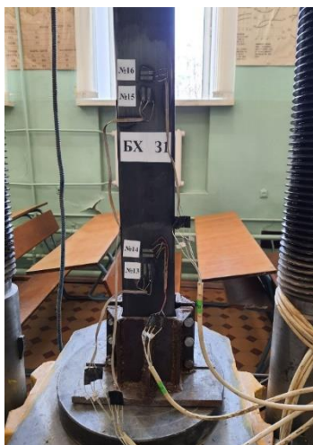
Рис. 8. Розміщення тензорезисторів на дослідному зразку
