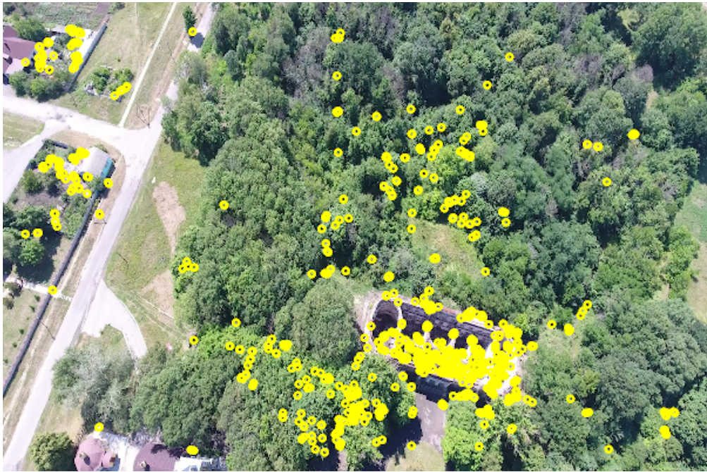
Рис. 1. Ілюстрація нерівномірності покриття зображення ключовими точками, що знайдено за алгоритмом ORB
